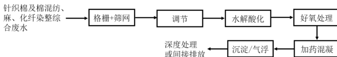
图 6.2-6 化纤染整的综合废水常规处理工艺流程示意图（HJ471-2020）
